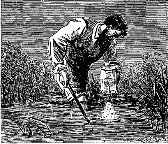
Fig. 70. Dégagement du gaz des marais.
