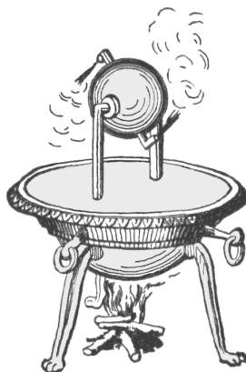
Figure II.13 : Machine similaire à celle de Héron. De l'eau est portée à ébullition dans un récipient fermé, de la vapeur est dirigée dans les tuyaux qui arrivent dans la sphère qui peut tourner, et des jets de vapeur latéraux la mettent en mouvement.
