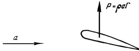
Figure IX.13 : Portance s'exerçant sur l'aile due au flux arrivant à la vitesse  $a$ . La direction de la portance dépend du sens de la circulation  $\Gamma$ , laquelle dépend de la position de l'aile dans le flux.
