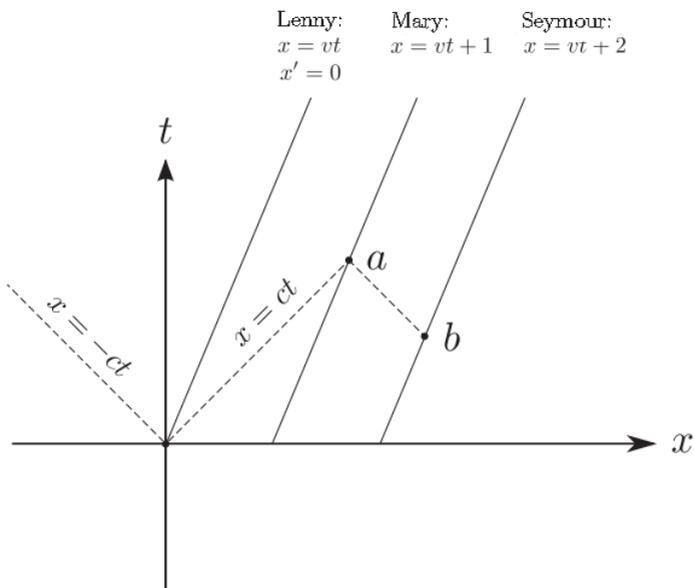
Figure 1.2 : Détermination de la synchronicité dans le référentiel en mouvement.
