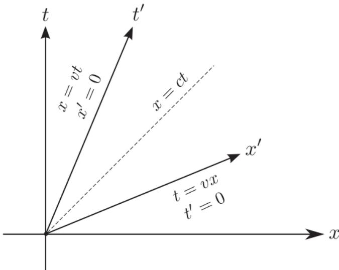
Figure 1.4 : Référentiels fixe et en mouvement de la relativité restreinte. Schéma simplifié.
